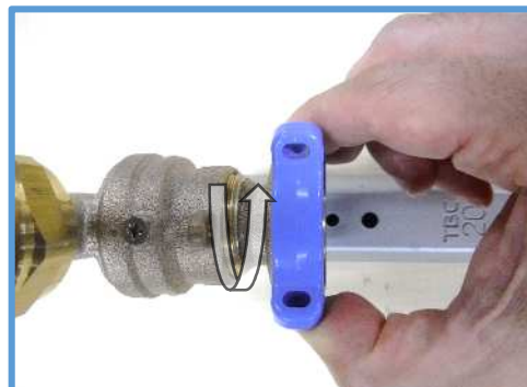
送りハンドルを”O”方向に回しねじ込み
